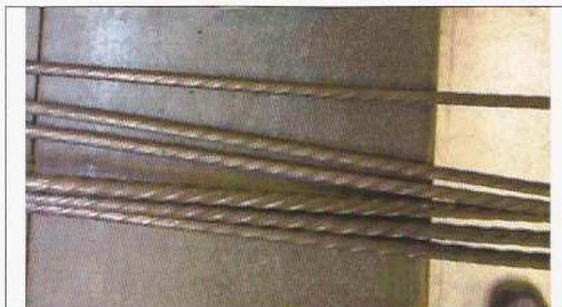
**Fotografía 2.1.1:** Vista general de las probetas de varillas entregadas para la realización de ensayos de tracción universal.
