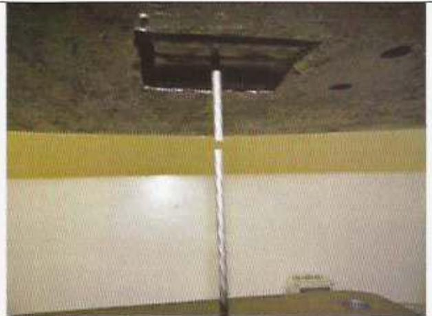
**Fotografía 4.1.2:** Vista general del mecanismo de falla típico que se presentó en las probetas sometidas al ensayo de tracción directa.
